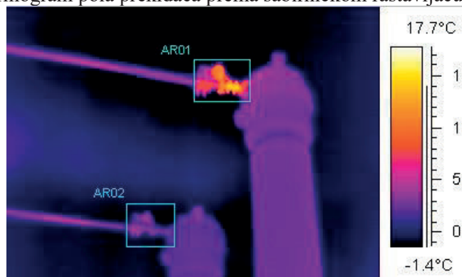
Slika 8: Termogram pola prekidača [3]
